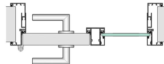
A + B | Stipite a baionetta in alluminio con montante ed elemento laterale in vetro in superficie bianca, RAL 9016
